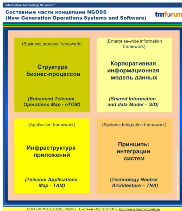
Рис. 1 Составные части концепции NGOSS (New Generation Operations Systems and Software)
