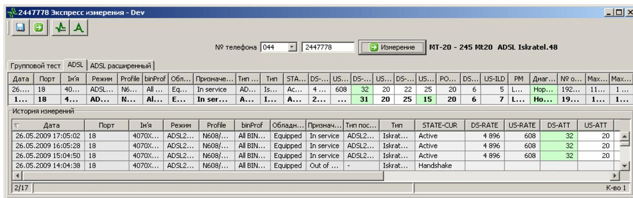
Рисунок 6. Окно Экспресс измерение с результатами базового тестирования ADSL
